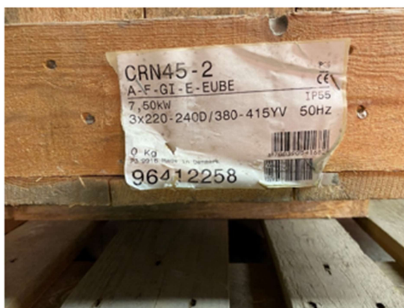
Pumpe for mindre trykkøkingsstasjon (i kasse). (Se bilde over).
