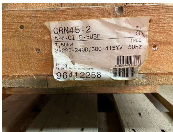
Pumpe for mindre trykkøingsstasjon (i kasse). (Se bilde over).
