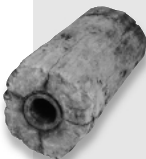
Eksempel på gammelt vannrør som var laget av et uthult trerør.
